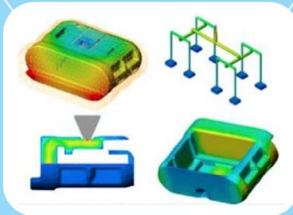
Wir erstellen Spritzgießsimulationen mit **SOLIDWORKS Plastics**. Rheologische und Thermodynamische Vorhersagen führen wir dadurch sowohl für kristallisierende als auch vernetzende Kunststoffe hinsichtlich Füllung und Verzug durch.
