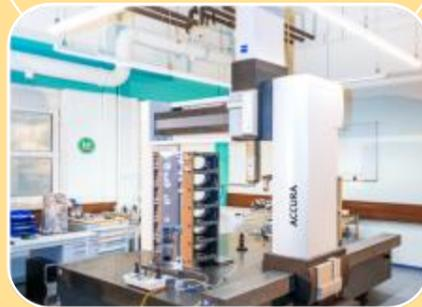
Für taktile Messungen setzen wir 4 Zeiss 3D-Koordinatenmessmaschinen ein. Für Serienmessungen oder große Bauteile steht uns ein maximaler Verfahrensweg in Y von 2.400 mm zur Verfügung.
